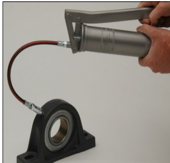
Mit Handfettpresse Lager durchschmieren
