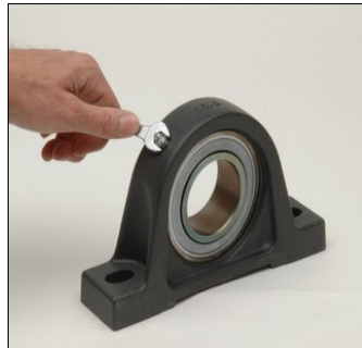
Schmiernippel am Lager mit Gabelschlüssel heraus-schrauben
