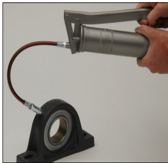
Mit Handfettpresse Lager durchschmieren
