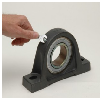
Schmiernippel am Lager mit Gabelschlüssel heraus-schrauben
