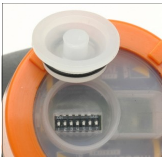
Schutzdeckel abnehmen und Schmierstoffgeber einschalten
